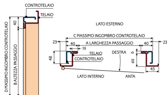
MISURE STANDARD PER IL TELAIO RIDOTTO E CONTROTELAIO SUPER RIDOTTO
